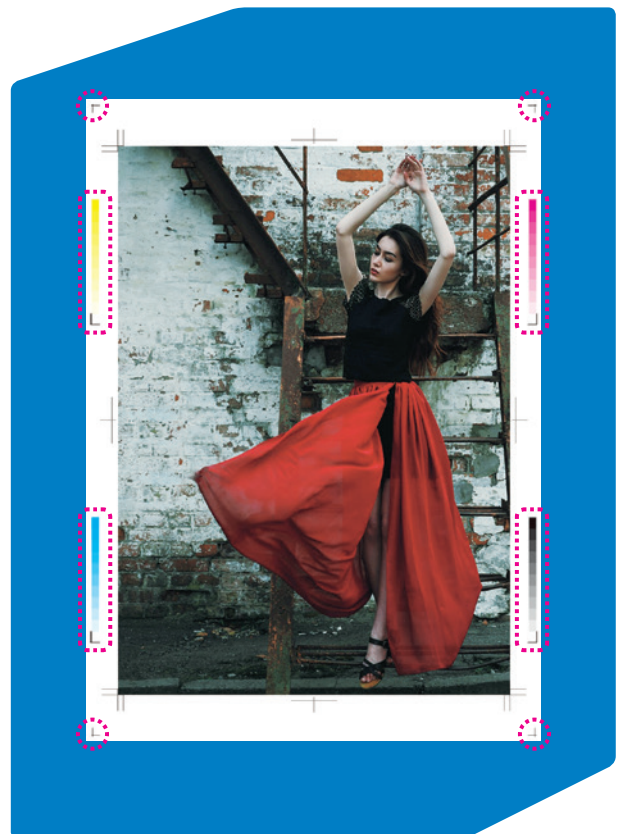
Impresión, escaneado y análisis automático de las marcas de registro de tolerancia y de degradados.
